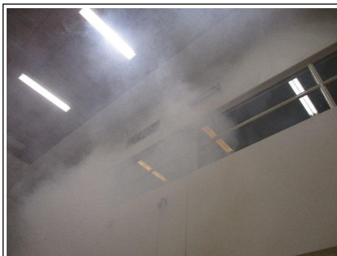
Kuva 8.4 Liikuntasalin poistot, savu virtasi poistoilmasäleiköille
