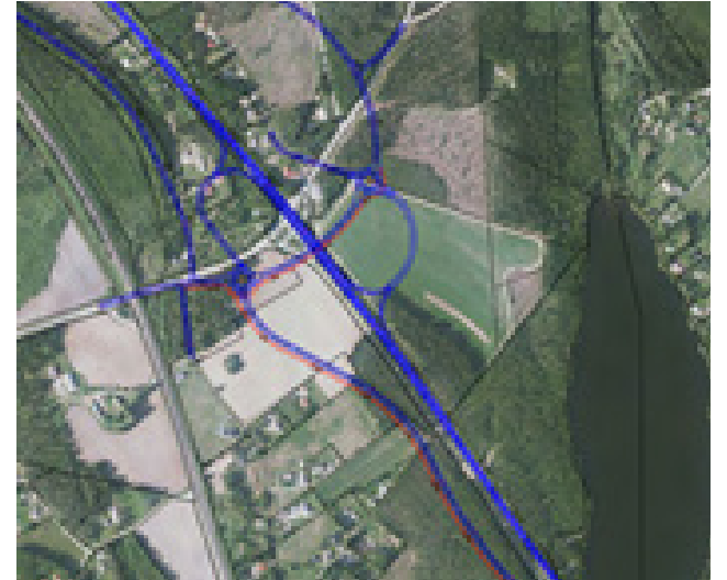
Kuva 39. Vaihtoehdotarkastelussa linjausvaihtoehdossa VE 2 parhaaksi valikoitunut liittymäratkaisu, lohenpyrstö, jossa rampit sijoittuvat samalle puolelle risteyssiltaa.
