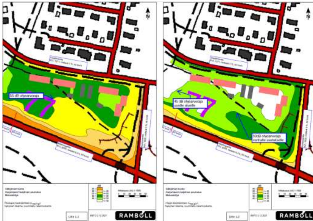
Kuva 8 Tieliikennemelun meluvyöhykkeet. Nykyinen liikenne, suunniteltu rakennuskanta (vasemmalla päiväajan ja oikealla yöajan keskiäänitaso)
