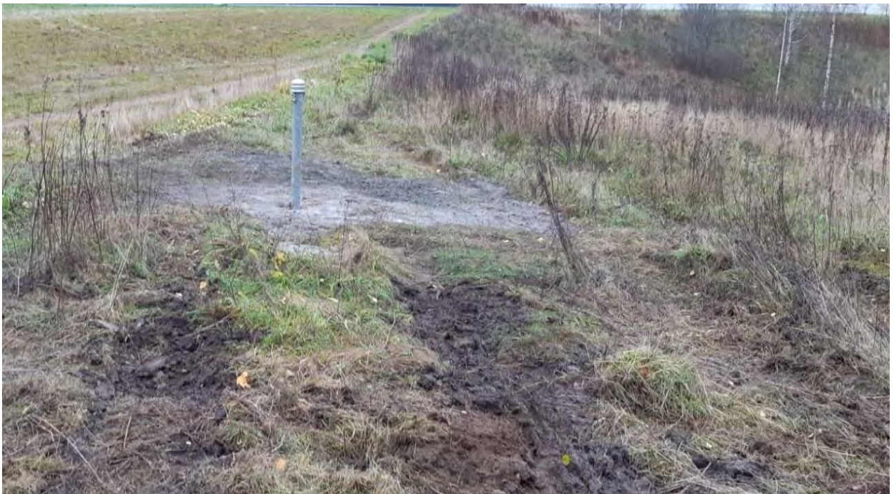
Kuva 5. Havaintoputki GTK 301_21 Kasurilan alueella asennettuna pellon reunaan. Kuva GTK.
