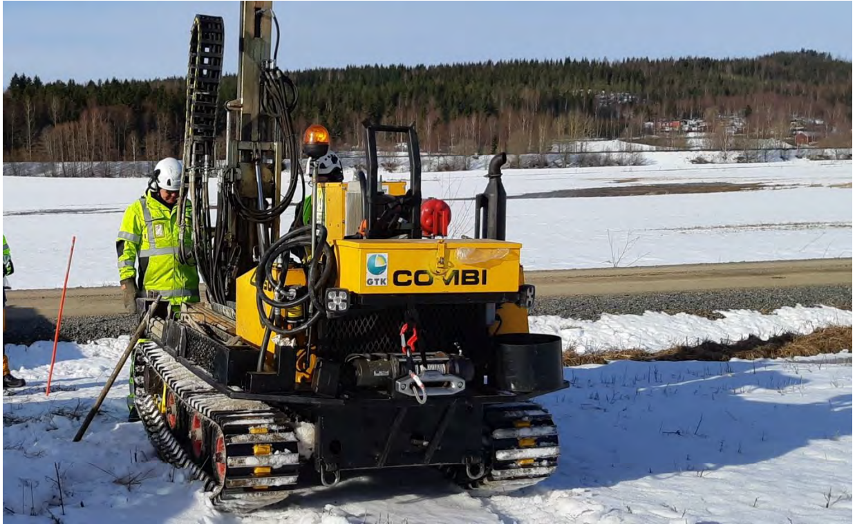
Kuva 8. Maaperäkairausta GTK:n kevyellä GM50 kairakoneella Jälän peltoalueilla taustanaan Kasurilanmäen Kalkkivuorta. Kuva GTK.
