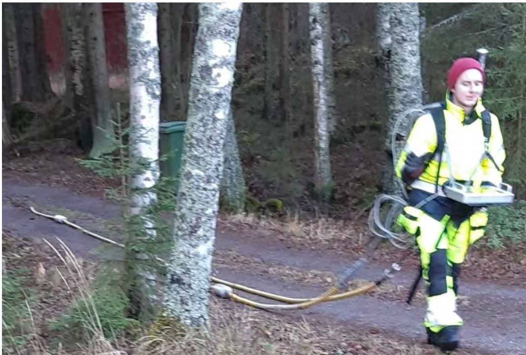
Kuva 9. Maastokelpoinen Malå ProEx maatutkalaitteisto varustettuna 25 MHz ja 100 MHz RTA-letkuantenneilla ja GPS-paikannuslaitteistolla. Kuva GTK.
